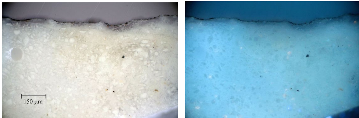
Obr. 30, 31: Vzorek odebraný z části poškozeného nosu v optickém mikroskopu Eclipse LV100D-U (Nikon) v bílém viditelném a UV světle. Ze vzorku je patrné, jakým způsobem jsou depozity propojené se substrátem a že sádra pravděpodobně nebyla nijak povrchově upravována.
