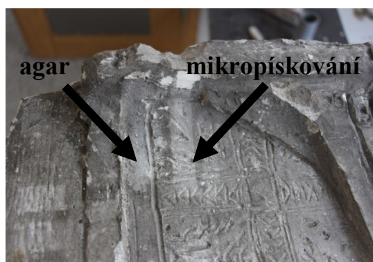
Obr. 25, 26: Zkoušky čištění agarem i mikropískováním projevovaly poměrně optimální výsledky. Při zkoumání v UV světle se však u agaru ukazuje negativní jev fluorescence kolem čištěného místa, která je způsobena penetrací média do porézního systému substrátu.
