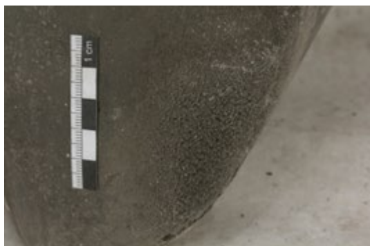
Obr. 1: Povrch poškozený přímým kontaktem s vodou.
