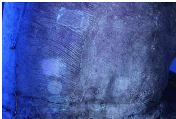
Obr. 12, 13: Zkoušky čištění je nutné důkladně zdokumentovat pro zdůvodnění výběru a koncepce. Jsou obvykle prováděny na zadních či bočních stranách odlitku, které jsou skrytější přímé konfrontaci s divákem. Na obrázku jsou vidět vzorky provedené agarem, lasery, plastickými gumami i smáčenou vatovou tyčinkou.
