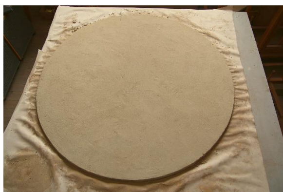
Obr. 26: Celkový pohled na rubovou stranu mozaiky s druhou vrstvou omítky – z Poraveru a přírodně hydraulického vápna.
