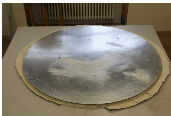
Obr. 28: Celkový pohled na rubovou stranu mozaiky s nalepeným voštinovým panelem.
