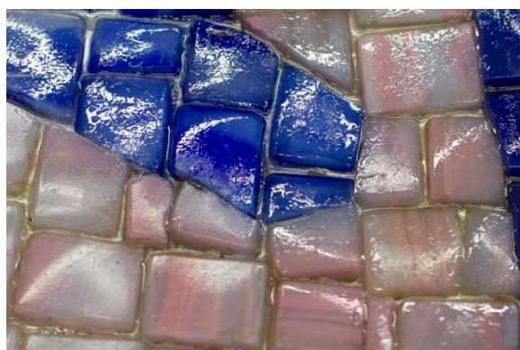
Obr. 37: Epoxidová pryskyřice na pohledové straně kostek vytváří lesklejší povrch než u originálu a je nutné ji odstranit.
