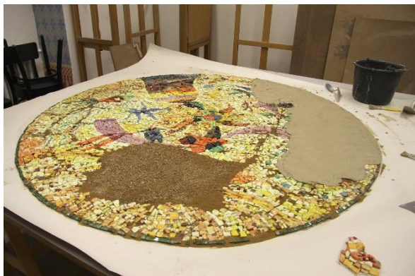
Obr. 23: Průběh nanášení první vrstvy omítky (z písku a přírodně hydraulického vápna) na rubovou stranu mozaikových kostek.
