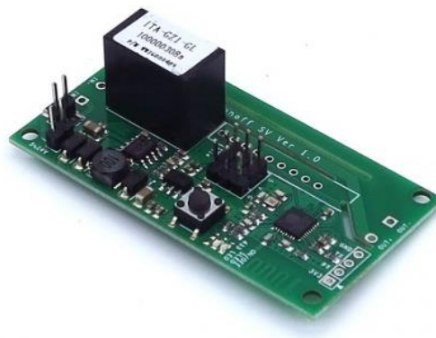
Obrázek 9 – Ukázka bezdrátového relé Sonoff SV [16]
