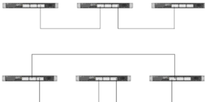
Obrázek 5: Topologie Cascade a Ring
