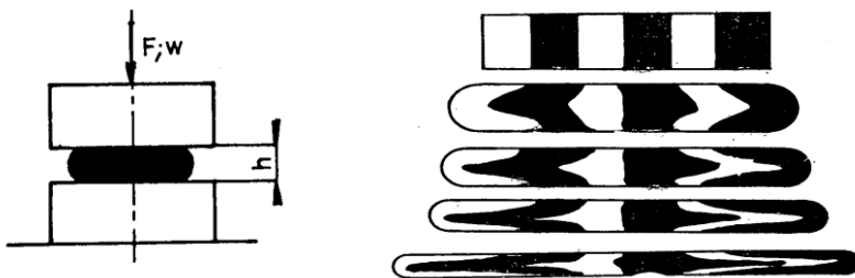
Obr. 8.1. Lisování plochého polotovaru. Vpravo: tok skloviny během lisování [4].
