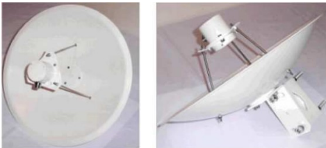
Obr.7.10 Příklad antény pro přenos dat v pásmu 5,8 GHz. Uprostřed v ohnisku paraboly je zářič-vysílací anténka ve vlnovodu podle obr.7.9. místění vysílací antény
