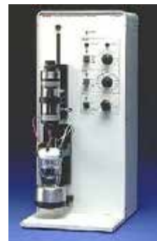
Obr.: Visící Hg-kapka v komerční podobě
