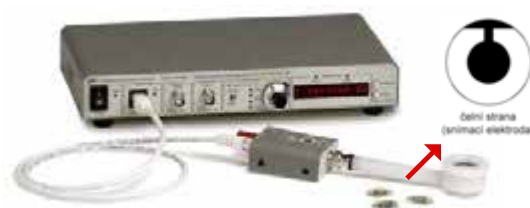
Obr.: Zařízení pro EQCM, včetně kruhového držáku do něhož se vkládají 3-el. cely (dole + detail nahoře)
