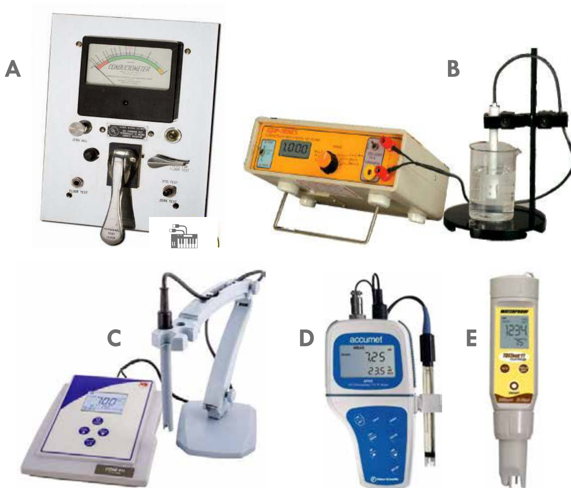
Obr.: Konstrukce přístrojů k měření vodivosti v průběhu času. Legenda: A ... historický aparát (ze 30-tých let min.st.); B ... analogově-digitální konduktometr II. generace; C ... plně digitální konduktometr současnosti pro rutinní laboratorní použití, D,E ... zmenšené přenosné verze.
