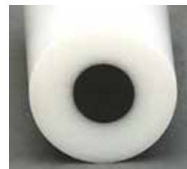
DETAIL 2: Vyleštěná povrchová vrstva skelného uhlíku, jehož roubík je zasazen v teflonovém těle, uvnitř s elektrickým kontaktem
