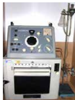
Obr.: Polarograf II. generace s připojeným liniovým zapisovačem Model firmy Laboratorní přístroje, n.p.; (typ "LP02", rok 1960)
