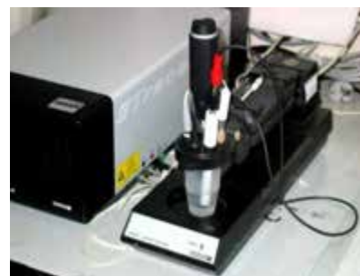
Obr.: Jednoučelový analyzátor PSU™ pro stripping potenciometrii patří k základní výbavě ESA v ESB
