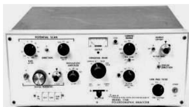
Polarografický analyzátor, analogový pro připojení k zapisovači či PC (cca 1970)
