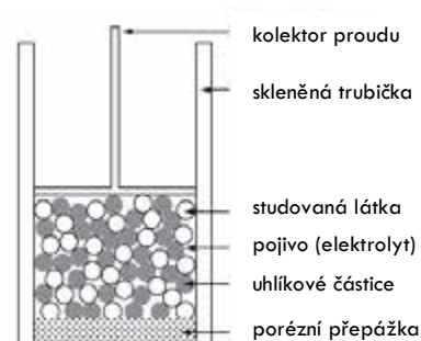
Obr.: Jedna z tradičních konfigurací tzv. uhlíkové pastové elektroaktivní elektrody (CPEE)
