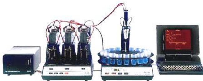
Obr.: Příklad přístroje pro stripping potenciometrii v kompletní výbavě pro automatizovaná měření. Model PSU® fy Radiometer
