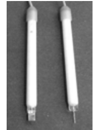
Obr.: Dvě různé konstrukce Pt-elektrody: (i) plíšek, (ii) drátek ▶
