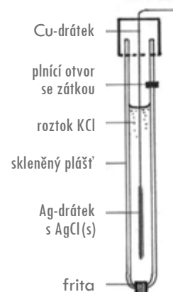
Obr.: Chloridostříbrná elektroda. Konstrukce
