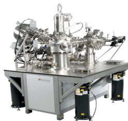
Obr.: Skanovací tunelový mikroskop (STEM) se speciálním snímacím (nano)hrotem byl jedním z prvních moderních mikroskopických přístrojů, použitý ke studiu morfologie uhlíkových past.
