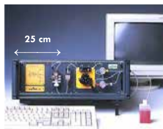
Odshora, zleva : Coulometrický titrátor s dávkováním; coulometr ke stanovení vody metodou dle Karl Fischera; laboratorní sestava pro analýzu mořské vody (ke stanovení vybraných kovů, celkové alkalinity a obsahu kyslíku); zařízení pro průtokovou (chono)coulometrii: celková sestava s PC, detail průtokové elektrodové cely s porézni pracovní elektrodou a hadičkového čerpadla.
