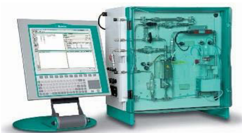
Odshora, zleva : Coulometrický titrátor s dávkováním; coulometr ke stanovení vody metodou dle Karl Fischera; laboratorní sestava pro analýzu mořské vody (ke stanovení vybraných kovů, celkové alkalinity a obsahu kyslíku); zařízení pro průtokovou (chono)coulometrii: celková sestava s PC, detail průtokové elektrodové cely s porézni pracovní elektrodou a hadičkového čerpadla.
