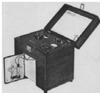
Jeden z prvních komerčně vyráběných pH-metrů s příslušenstvím (cca 1930)
