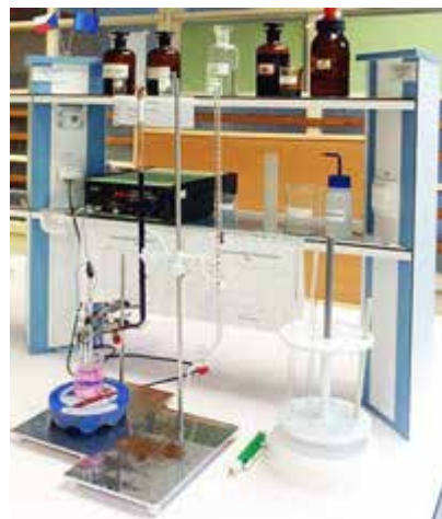
Obr.: Sestava pro potenciometrická měření. Ilustrační foto
