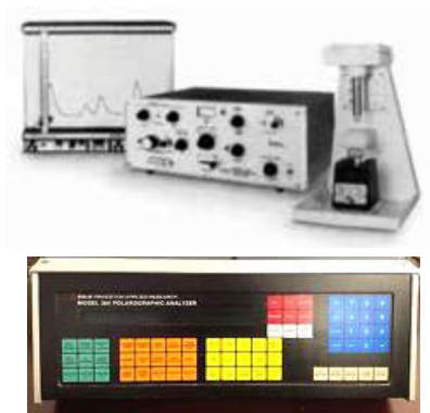
Obr.: Analyzátory II. generace. Výrobky fy Princeton Applied Research, modely: nahore ... PAR 174-A, kompletní sestava dole ... PAR 384-A, přístroj: čelní panel
