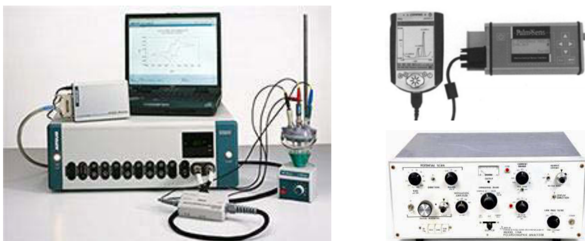
Obr.: Komerční sestavy elektroanalytických analyzátorů. vlevo ... Standardní model poslední generace (v měřítku 1:10); vpravo nahoře ... přenosný minianalyzátor + periferie (i-pod) (cca 1:3); vpravo dole ... pro porovnání klasický analogový přístroj (detaily, viz cit. [2]).
