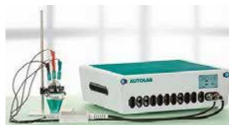
Obr.: Elektrochemický analyzátor fy Metrohm. Model Autolab ML s plným příslušenstvím
