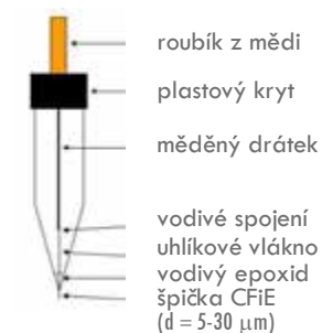
Obr.: Konstrukce některých elektrod používaných ve voltametrii. Vlevo: sada vyměnitelných koncovek jako pět různých pevných elektrod (zleva: prázdné pouzdro pro naplnění elektrodovým materiálem dle vlastní volby, Pt-, Au-, Ag- a GC-disky); uprostřed: dva konstrukční typy tištěných elektrod, A ... miniaturní integrovaná 3-elektrodová cela, B ... SPCE; vpravo: schéma mikroelektrody z uhlíkového vlákna (CFiE).
