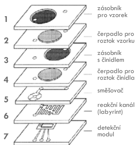
Obr.: Poslovnost jednotlivých segmentů u mikrofluidního systému pro ► elektrochemickou stripping analýzu v průtoku (převzato z cit. [9]).
