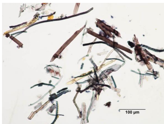
Obr. 3 Vzorek 2, vybarveno Graffovým“C“ roztokem, fragmenty roztokem zbarvených vláken hedvábí, vlákna a pokožkové buňky rýžové slámy, dobře viditelný škrob
