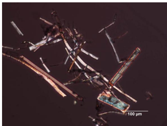
Obr. 5 Vzorek 2, vybarveno Graffovým“C“ roztokem, polarizace, fragmenty křehkého lýkového vlákna a hedvábí
