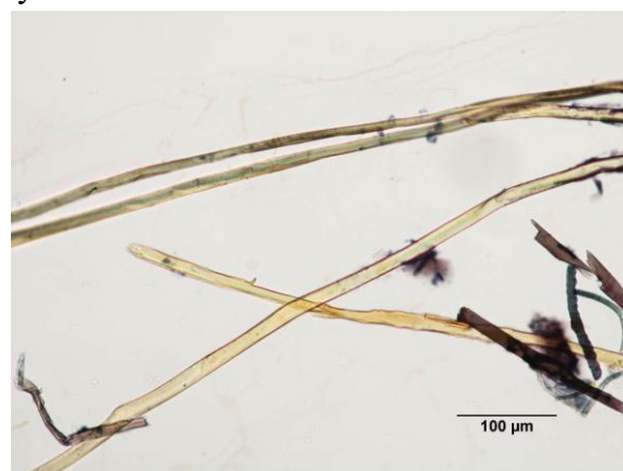
Obr. 4 Vzorek 2, vybarveno Graffovým“C“ roztokem, žlutá vlákna hedvábí
