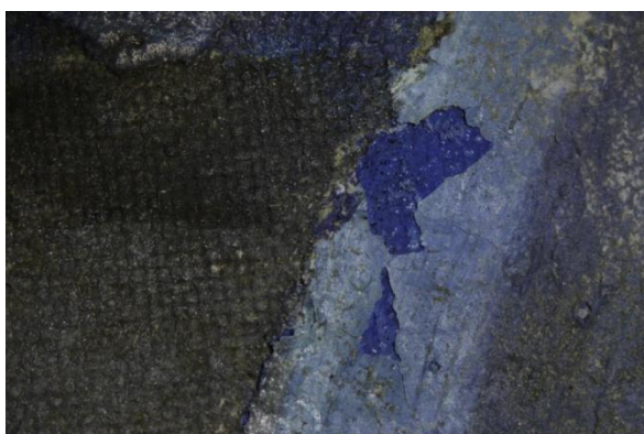
Obr. 18 Krakeláž a ztráta barevné vrstvy na textilní podložce (zvětšeno 20×)
