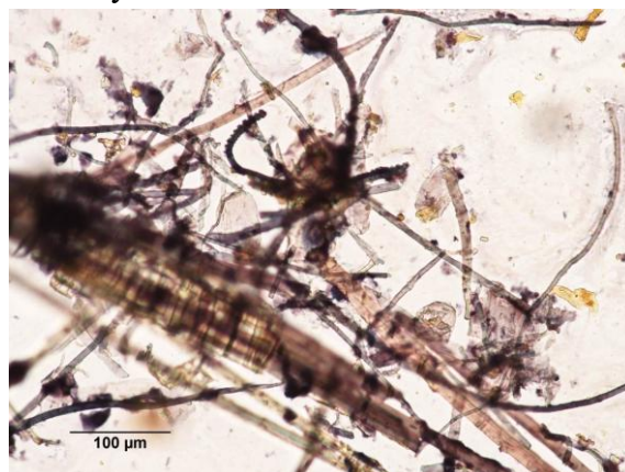
Obr. 8 Vzorek 3, vybarveno Graffovým“C“ roztokem, pokožkové buňky pravděpodobně rýžové a hnědě zbarvené lýkové vlákno
