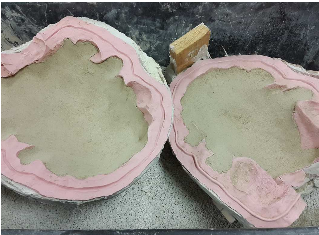
Obr. 73 - Dusání směsi do silikonové formy
