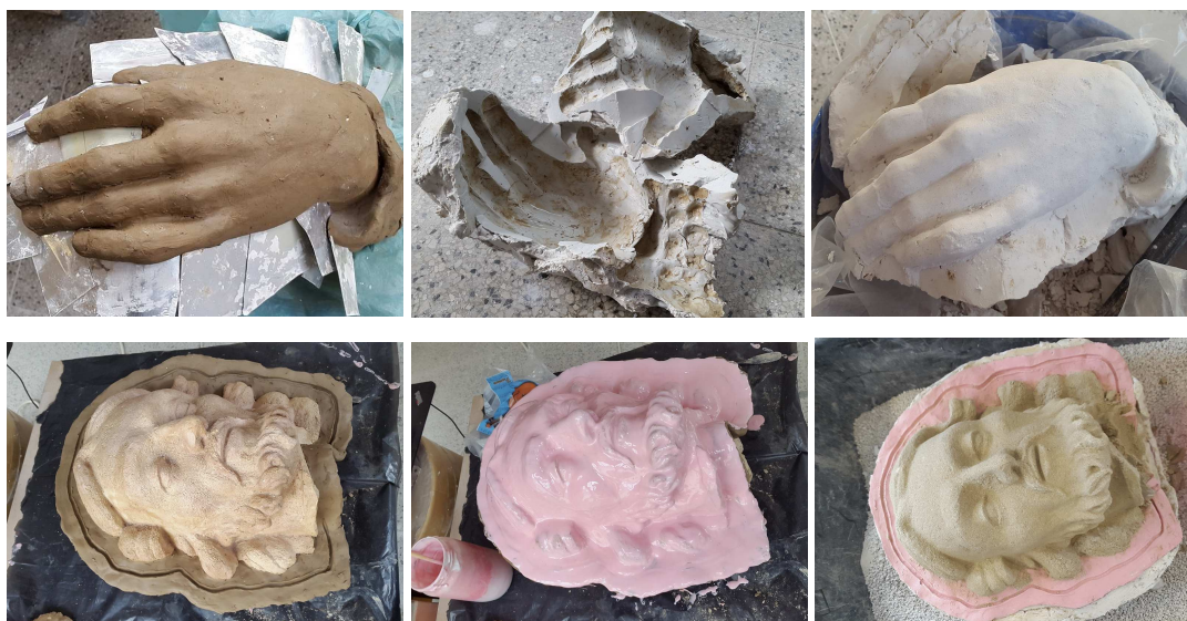
Obr. 31 – Proces vzniku výdusku – hliněný model (vlevo nahoře), sádrová forma (nahore uprostřed), sádro-pískový odlitek (vpravo nahoře), formování sádro-pískového odlitku (vlevo dole), silikonová forma (dole uprostřed), finální výdusek (vpravo dole)
