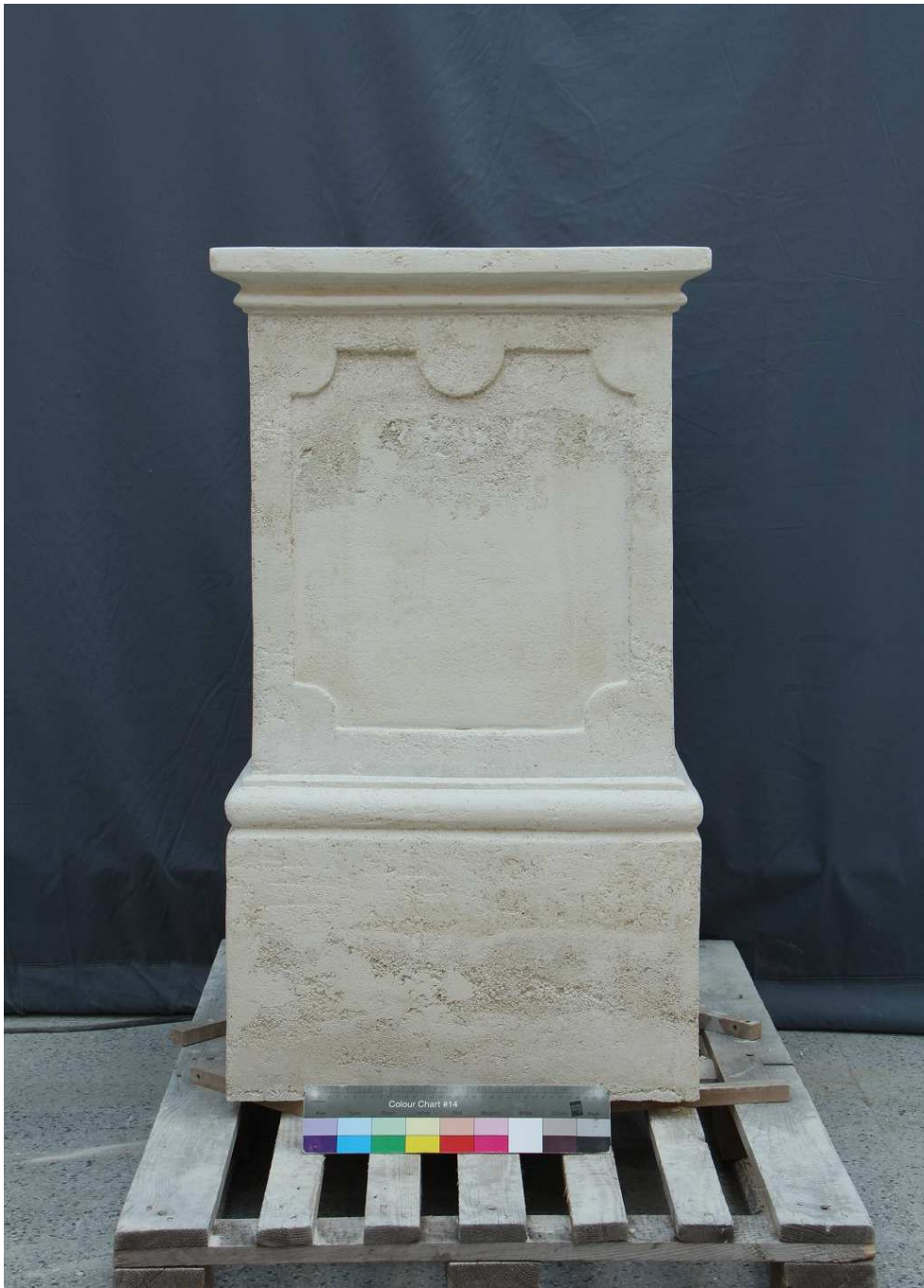
Obr. 80 - Vydusaný podstavec pod sochu (Boční pohled)
