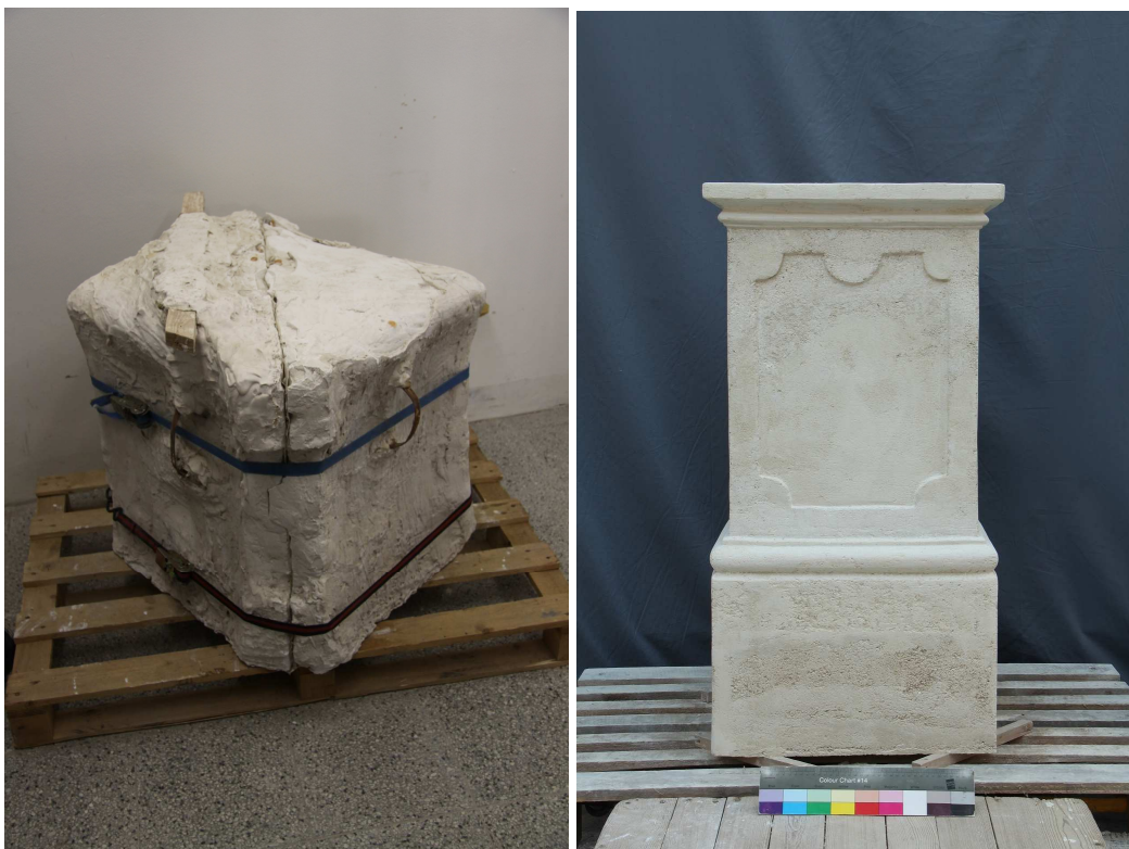
Obr. 34 – Silikonová forma pro podstavec (vlevo), vydusaný podstavec (vpravo)
