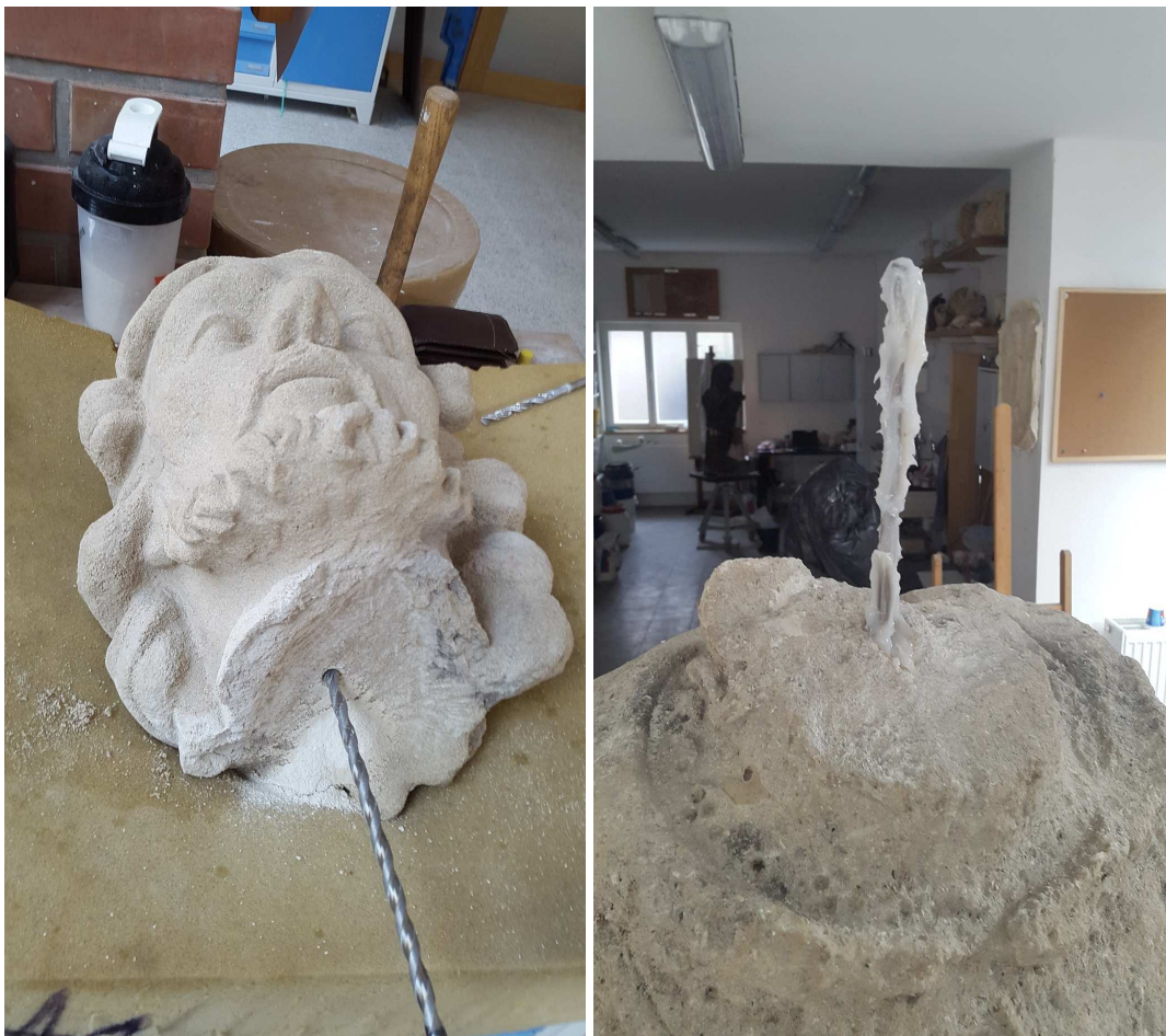
Obr. 32 – Vrtání otvoru pro čep (vlevo), připravený čep s epoxidovým lepidlem pro nasazení hlavy (vpravo)
