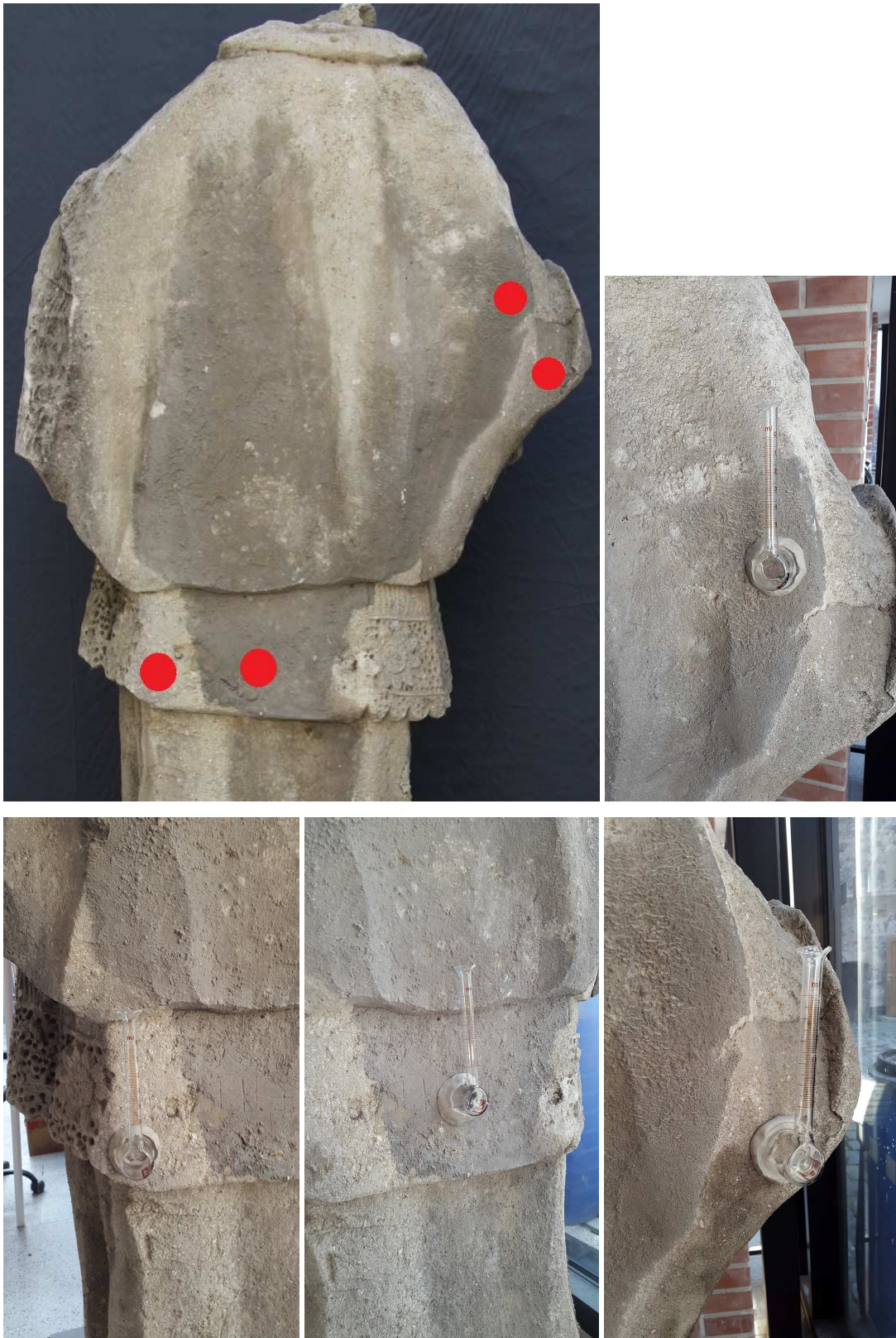
Obr. 10 – Místa měření kapilární nasákavosti pomocí Karstenovy trubice
