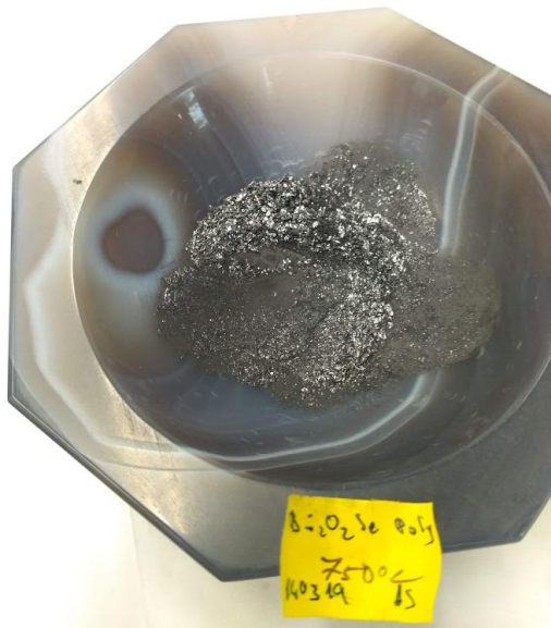
Obrázek 25: Vzorek temperovaný při 750 °C
