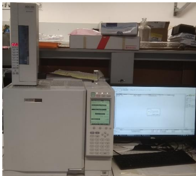
Obrázek 6 - plynový chromatograf GC2010
