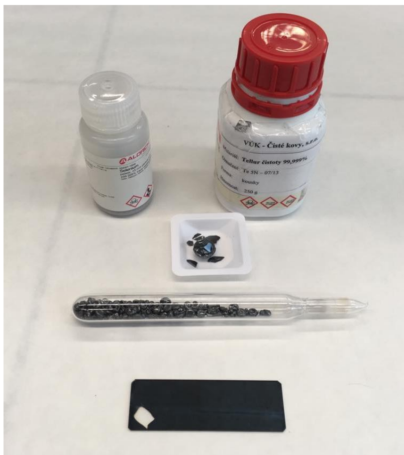
Obrázek 8: Ampule s čistými prvky a sklíčko s napařenou tenkou vrstvou \text{Se}_{95}\text{Te}_5
