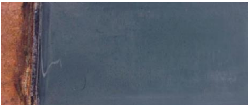
Měděná katoda se zinkovým povlakem – t=5 hod, K_{to}=5 \text{ mS}\cdot\text{cm}^{-1} , i_{prim.}=25,50 \text{ mA}\cdot\text{cm}^{-2}
