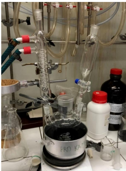
Obrázek 4: Aparatura pro přípravu oxidu železnato-železitého
