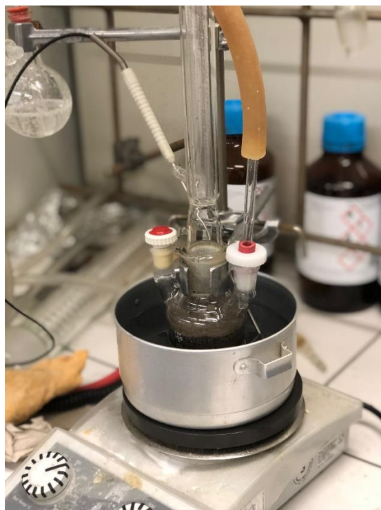
Obrázek 7: Polymerace reakční směsi
