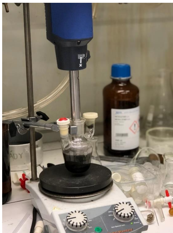
Obrázek 6: Homogenizace reakční směsi dispergátorem
