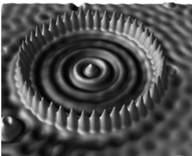
Obrázek 1: Kvantová ohrada ze 48 atomů železa o poloměru 7,3 nm. Snímek z mikroskopu STM [5]
