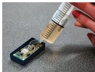
Obrázek 8 Zapouzdření elektronické součástky [30]
