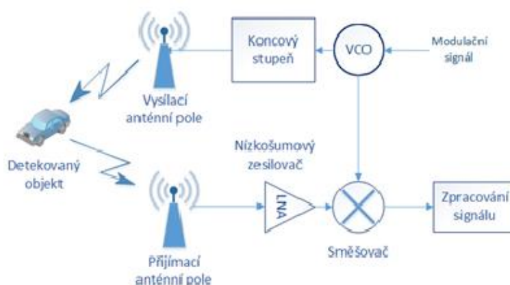
Obrázek 4 - Blokové schéma FMCW radaru
