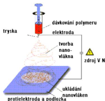
Obrázek 3: Typické uspořádání zařízení pro elektrostatické zvlákňování [36].
