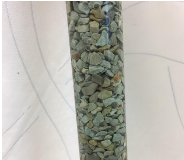
Příloha 5 Nedostatečná kultivace biofilmu D. hydrogenophilus u kolony plněné zeolitem
