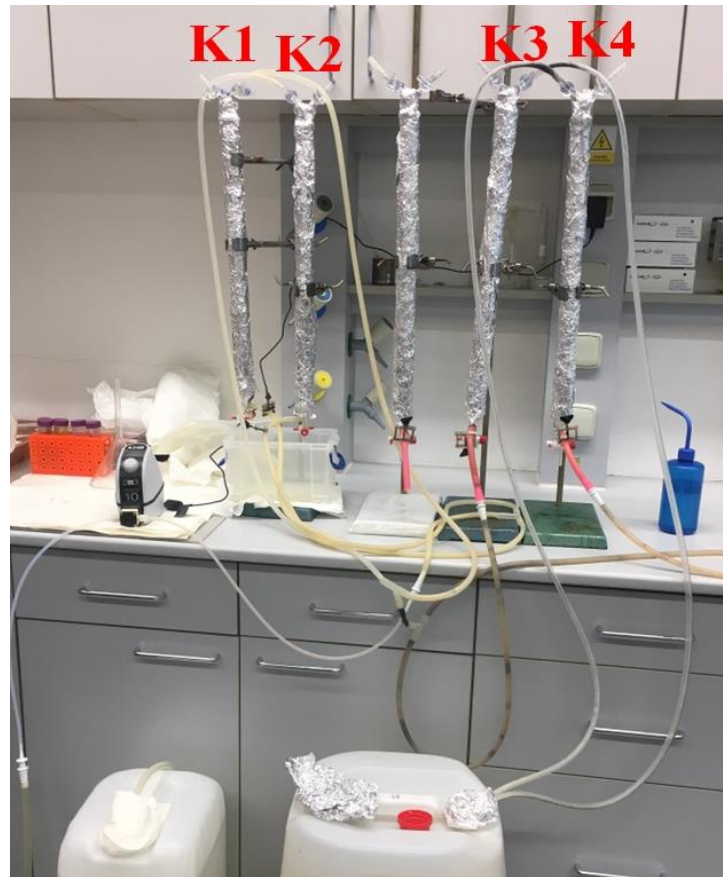
Příloha 4 Poslední fáze kolonového systému (dvoustupňové uspořádání), K1,2: kolony s akvaristickým nosičem Biomech a B. subtilis , K3: kolona s vápencem a D. hydrogenophilus K4: kolona s akvaristickým nosičem a D. hydrogenophilus
