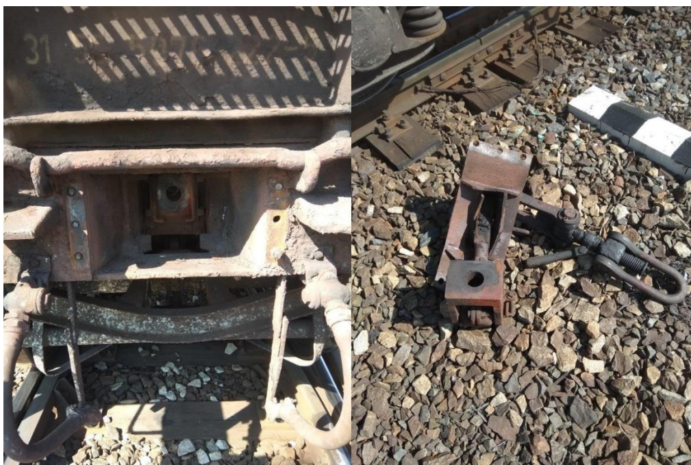
Obr. 11 Poškozené táhlové ústrojí nákladního vozu řady Eas, autor: Pavel Jaroš st..
