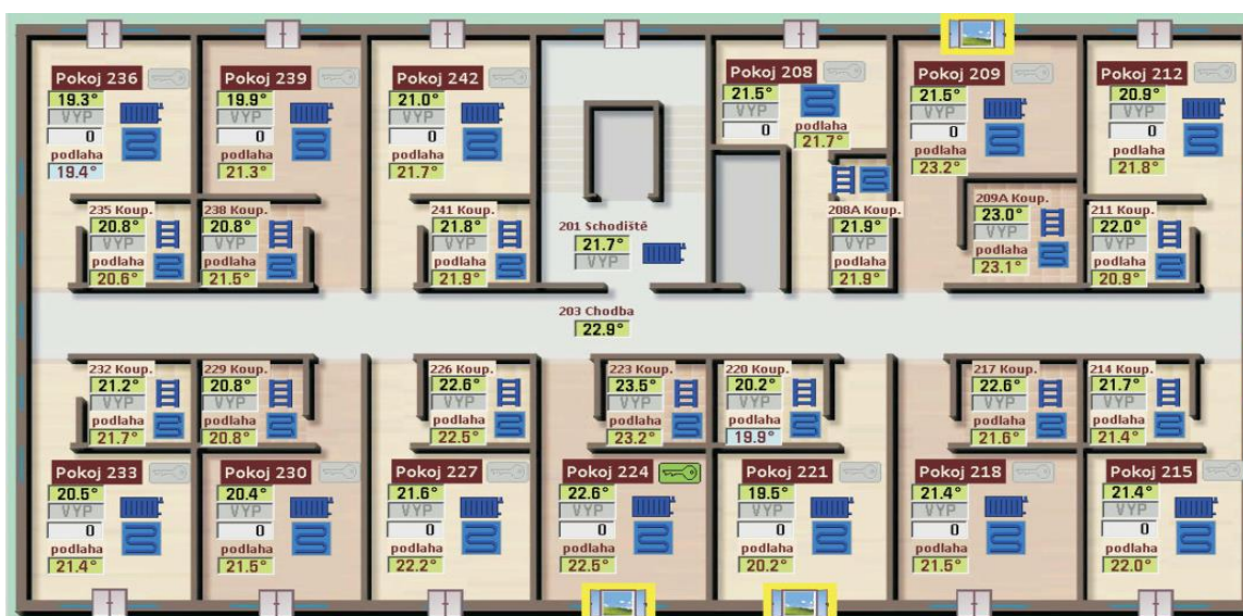
Obr. 3.1 – Příklad IRC regulace (Nbsinvest.cz, 2019)
