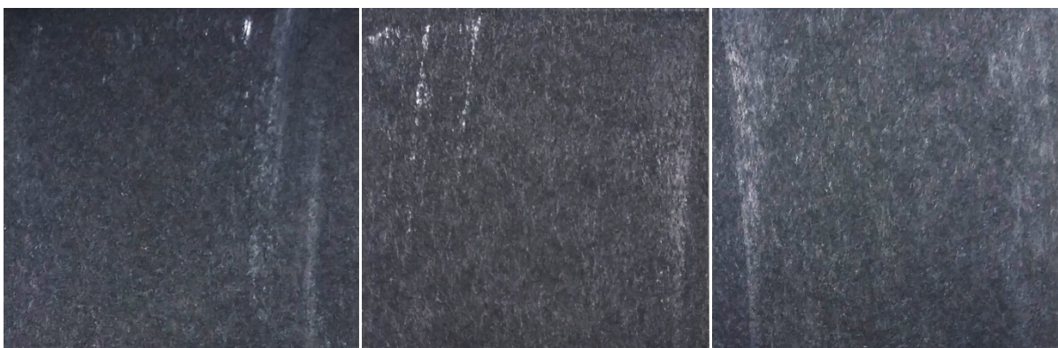
Obrázek 6: Vzorky testu oděru pro barvu Huber - přenesené množství barvy na protikusu; Zleva: Korsnas White, Stora Razor, Carrier Kote
