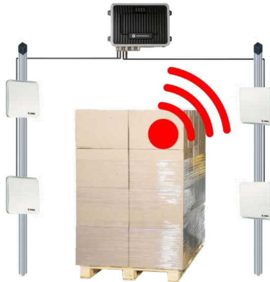
Obrázek 4 Modifikovaná RFID brána (Eprin, 2015)
