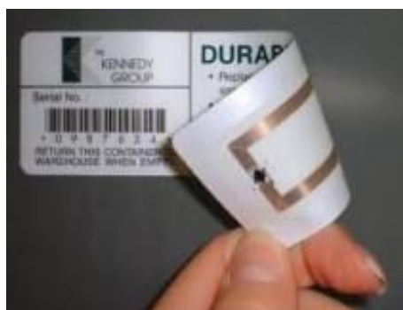
Obrázek 3 RFID tag – smart label (Bartech, 2008)
