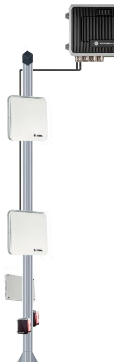
Obrázek 5 Část modifikované RFID brány (Eprin, 2015)
