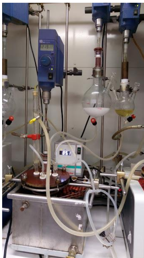
Obrázek 11. Aparatura pro přípravu akrylátového latexu s inkludovanými PPy částicemi.
