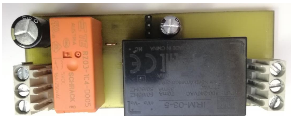
Obrázek 15: Napájecí deska shora
