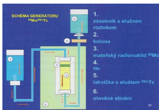
Obrázek 8 Schéma molybden – techneciového generátoru 8
