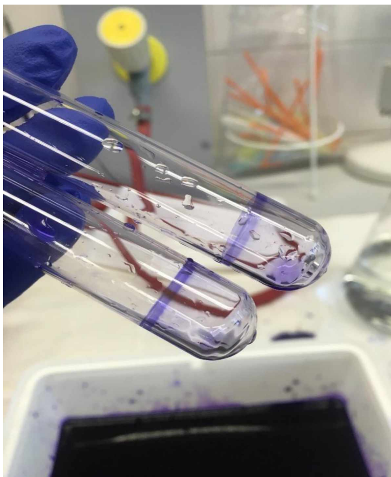
Obrázek 7 – Tvorba biofilmu ve skleněné zkumavce u kmene A. defluvii LMG 25694 – zkumavka vlevo aerobní atmosféra po 24 h; zkumavka vpravo mikroaerofilní atmosféra po 24 h (foto autor)
