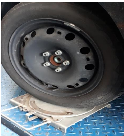
Obrázek 35 Měření úhlu natočení předních kol experimentálního vozidla
