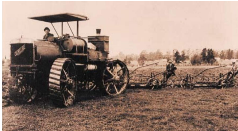
Obrázek 18 Traktor Caldwell první 4WS vozidlo [18]
