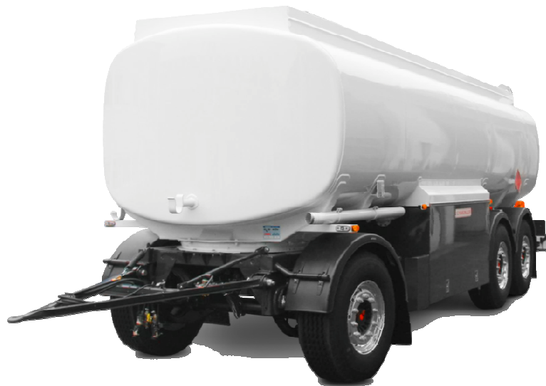
Obrázek 17: Nádrž skříňového tvaru [17]
