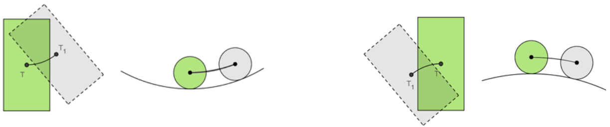
Obrázek 21: Stablní poloha a její opak (vratká) labilní poloha [8]
