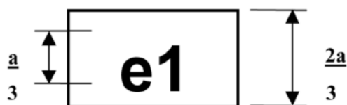
Homologační značka označující schválení dle technických předpisů ES/EU a její správné proporce (číslo 1 značí schválení v Německu)
