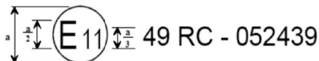
Příklad homologační značky udávající schválení výrobku podle předpisu EHK/OSN (zde konkrétně: dle předpisu č. 49, číslo 11 značí, že homologace byla udělena ve Spojeném království)
