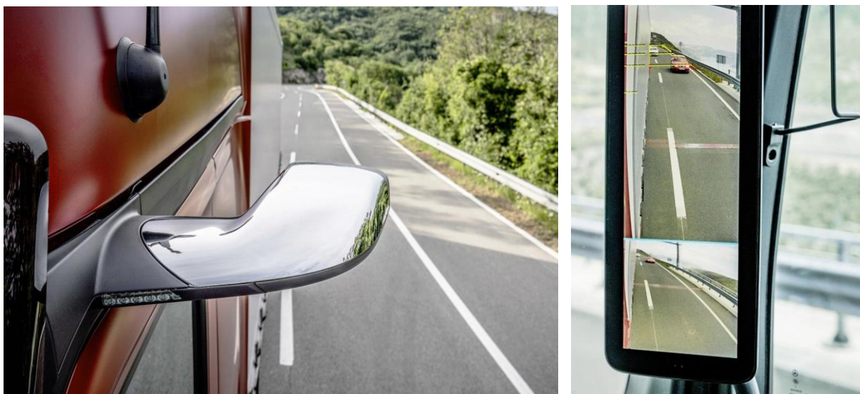
Obrázek 43 Systém MirrorCam (Mercedes-Benz, upraveno autorem, 2019)
