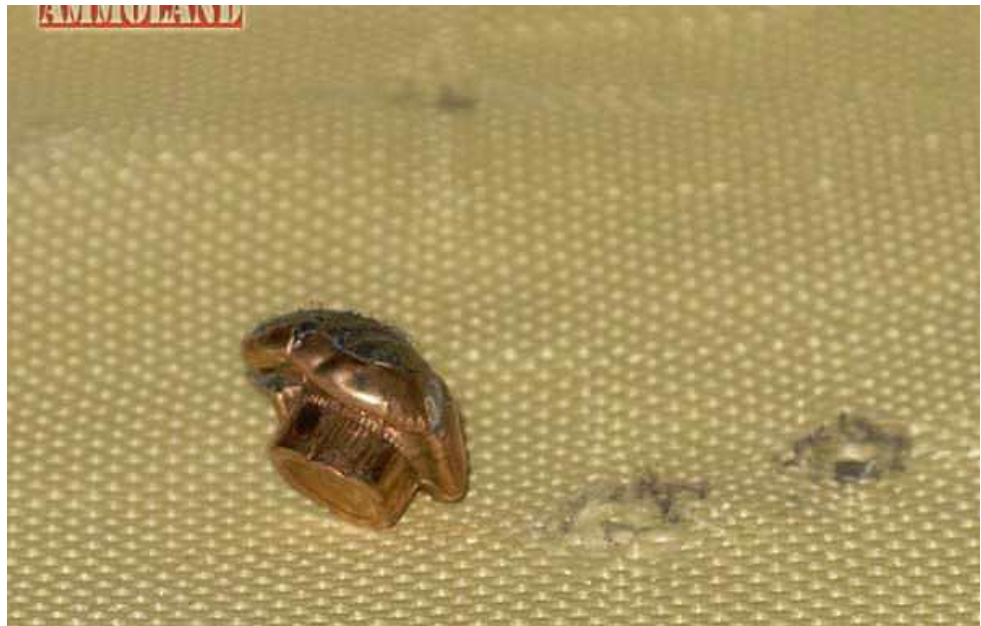
Obrázek 4: Balisticky odolná kevlarová tkanina s deformovaným projektilem [40]
