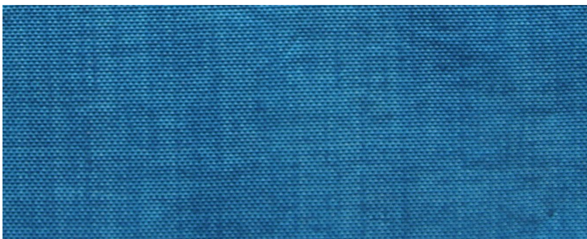
Obrázek 11: Pruhovité vybarvení polyamidové tkaniny, barvivo egacidová modř A2G ( Acid Blue 40 ) [23]
