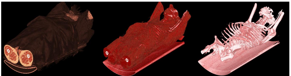
Obr. 22: Ukázka SSD při různých minimálních hodnotách voxelu
