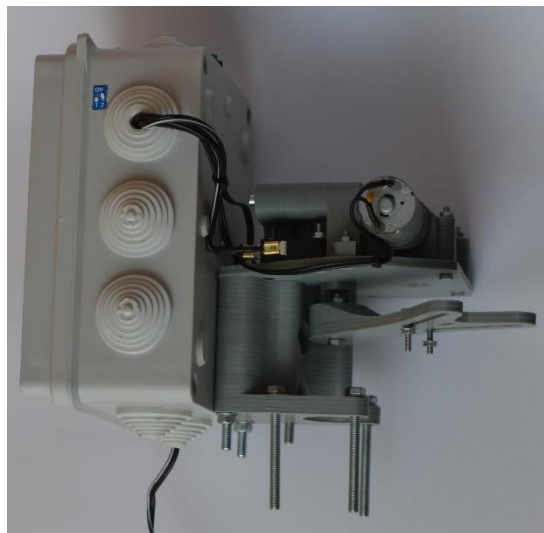
Obr. 1.12 – Zajištění vodičů a doplnění průchodek
