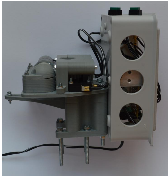
Obr. 1.11 – Uchycení základny k pohonu
