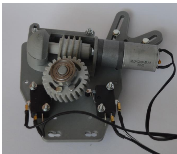
Obr. 1.6 – Přidání koncových dorazů
