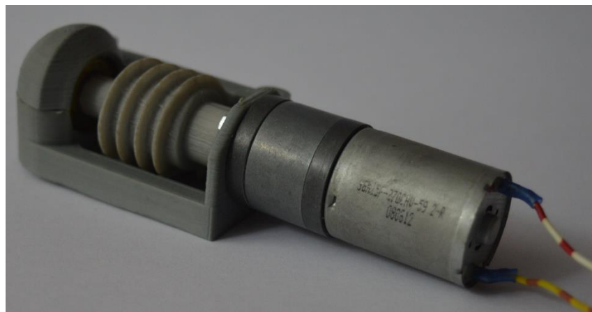
Obr. 1.2 – Připravený modul s šnekem a pohonem
