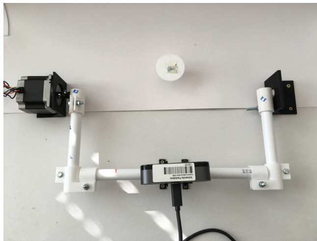
obr. 85: Pohľad z vrchu na prázdny disk, ktorý sa nachádza v ťažisku pohybu motorizovaného ramena.
