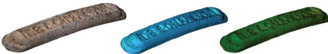
obr.16: Sieť bodov získaná fotogrametriou a 3D skenovaním. [22]
