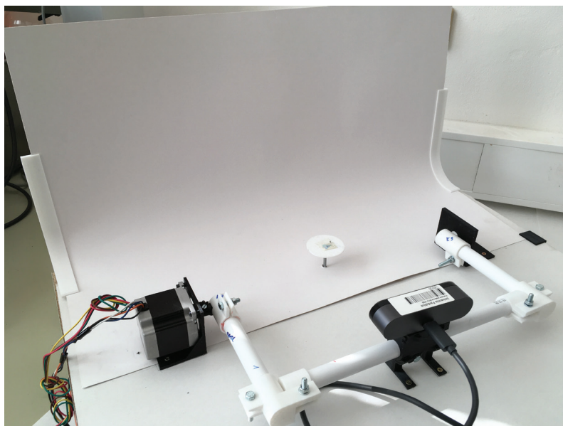
obr. 83: Pohľad na rameno umiestnené na vrchu platformy, ktoré je kontrolované motorom Microcon SX23. V strede ramena je umiestnená webkamera Logitech Brio s USB pripojením k počítaču. V ťažisku ramena sa nachádza platforma, ktorá s pomocou motora Microcon SX17 umiestneným zo spodu platformy vykonávala rotačný pohyb.
