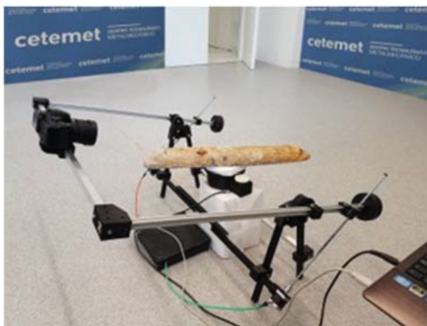
obr. 14: Získavanie fotogrametrických dát s využitím poloautomatického zariadenia [22]
