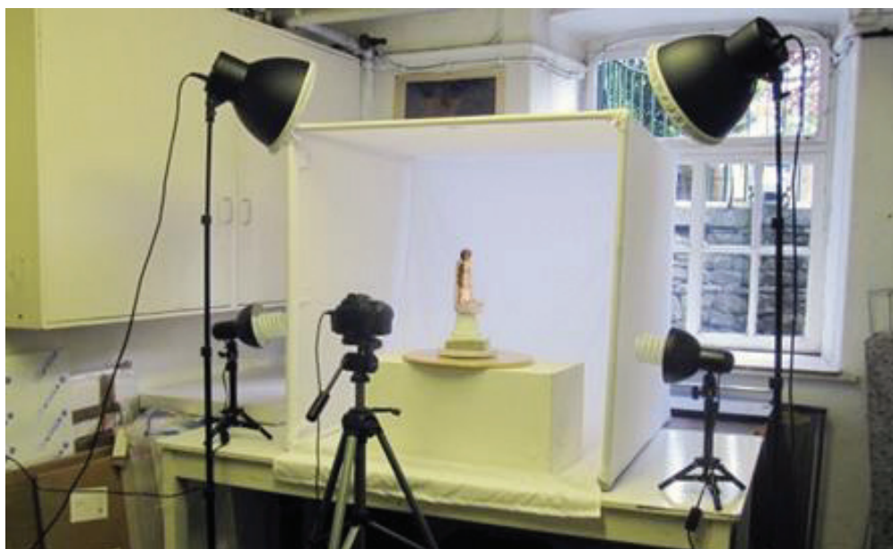
obr. 9: Vytvorený svetelný stan s rotačnou platformou, na ktorej je umiestnený fotografovaný objekt. [14]
