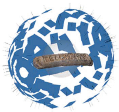
obr. 15: Jednotlivé pozície fotografií vytvorili guľovitý tvar [22]
