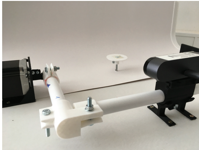
obr. 84: Biele pozadie, ktoré sa nachádzalo v zábere webkamery. Biely matný papier bol umiestnený tak, aby tvoril biele pozadie objektu pre každú polohu webkamery.
