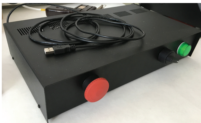
obr. 81: CNC USB Controller MK 3/4 v 1.0, ktorý bol pomocou USB kábla prepojený s počítačom.
