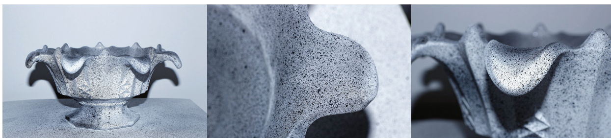
obr. 29: Transparentná váza po poprskaní čiernou farbou. [28]
