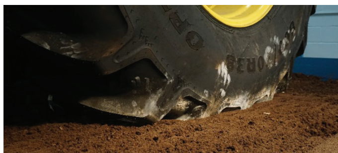
obr. 6: Laboratórne zaťaženie pôdy pneumatikou v nádobe s pôdou [20]
