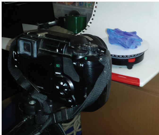
obr. 31: Fotografovaný kryštál bol pri fotení umiestnený na rotačnej platforme [26]
