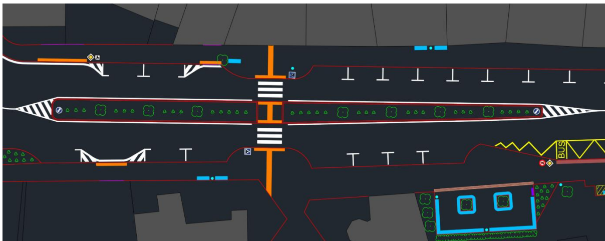
Obr. 25 Návrh středního dělicího pásu s přechodem pro chodce
