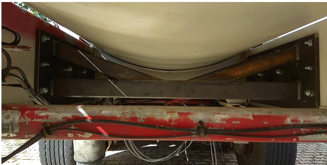
Obr. 2 – Rozpěra mezi podélníky rámu návěsu
