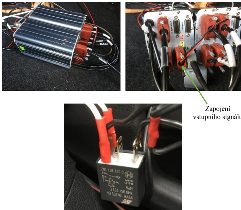
Obrázek 22: Zapojení měřicí ústředny a odpojovacího relé
