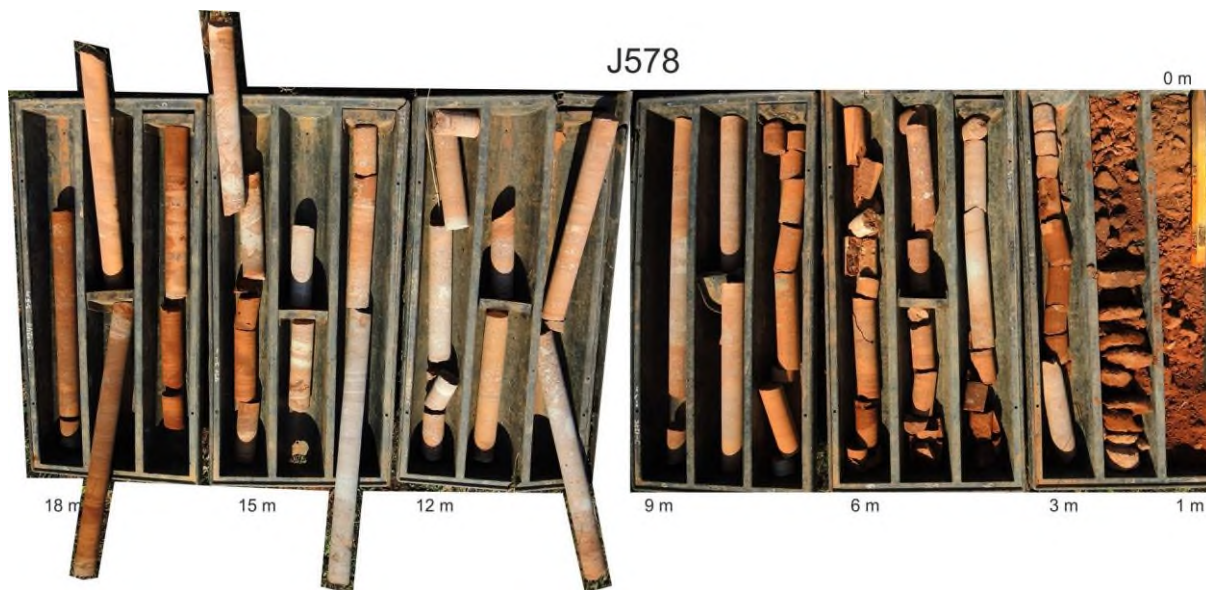
Obrázek 9 - Jednotlivá jádra rozdělená po metrových délkách, vrt J578
