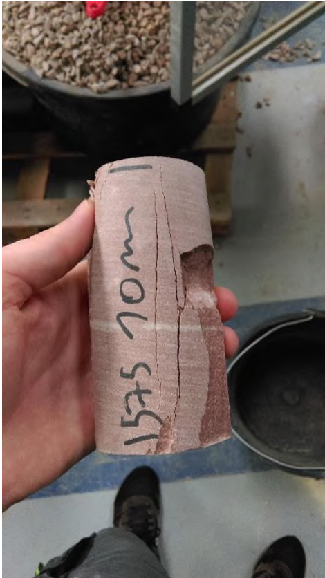
Obrázek 17 - Nejpevnější vzorek z vrtu J575 (Maximální síla - 400,17 kN)
