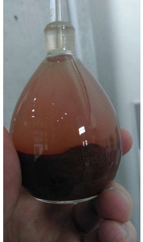
Obrázek 16 - Pycnometr, který prošel varem a je připravený na zvažení
