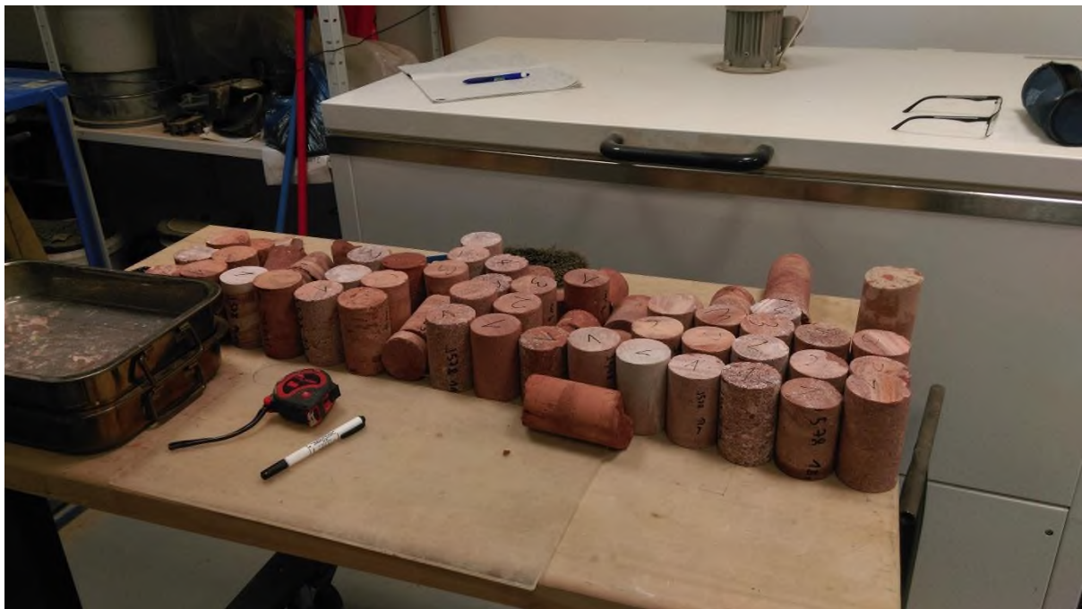
Obrázek 13 - Připravené vzorky na zkoušku v jednoosém tlaku
