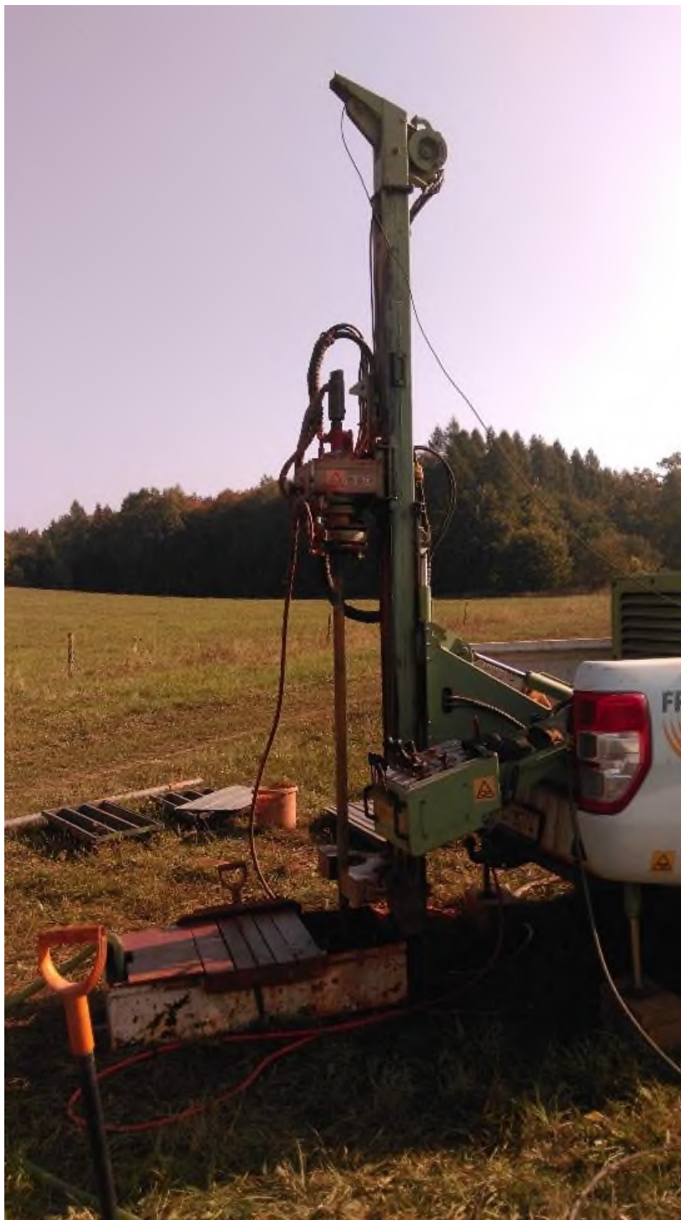
Obrázek 2 - Průběh vrtání s výplachem, vrt J577
