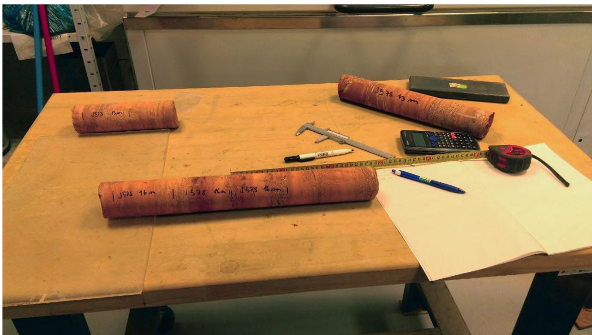
Obrázek 11 - Příprava odebraných jader vrtů na řezání
