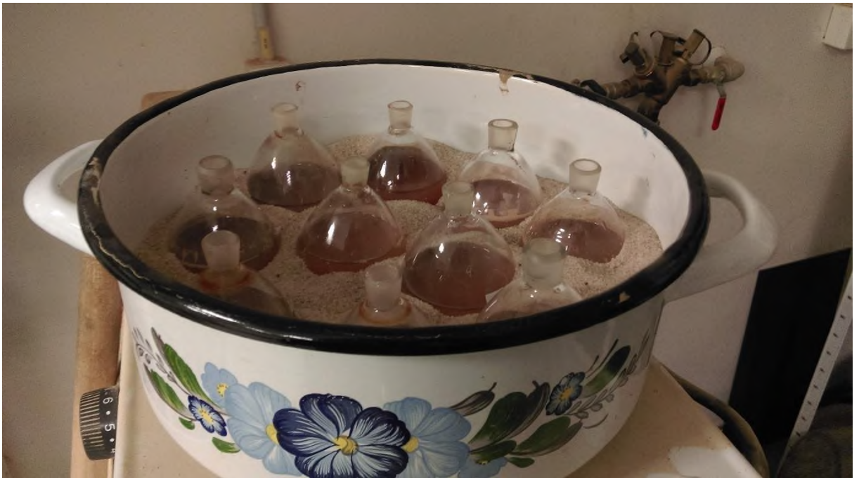
Obrázek 18 - Pycnometry naplněné do 2/3 výšky připravené k varu
