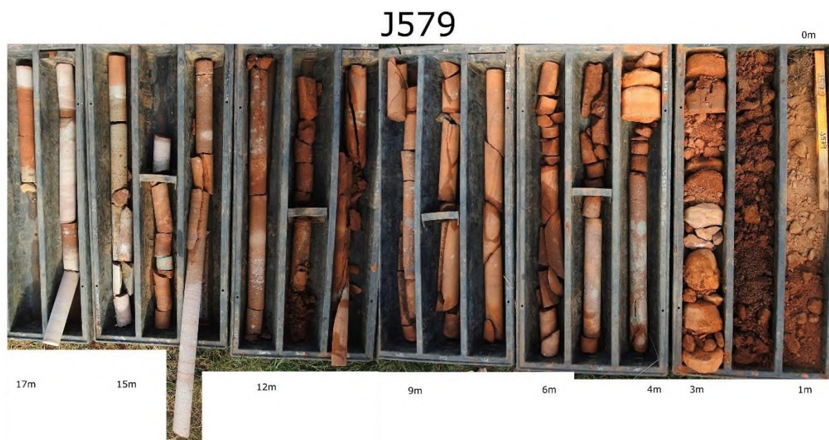
Obrázek 10 - Jednotlivá jádra rozdělená po metrových délkách, vrt J579
