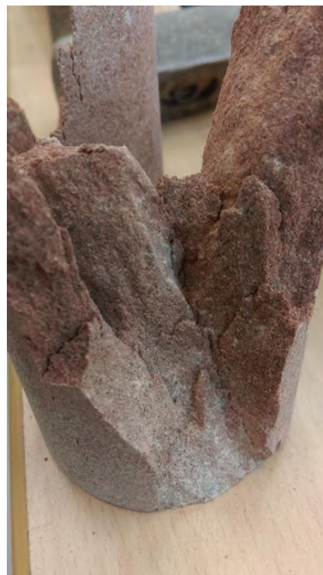
Obrázek 15 - Porušený vzorek po zkoušce pevnosti v prostém tlaku
