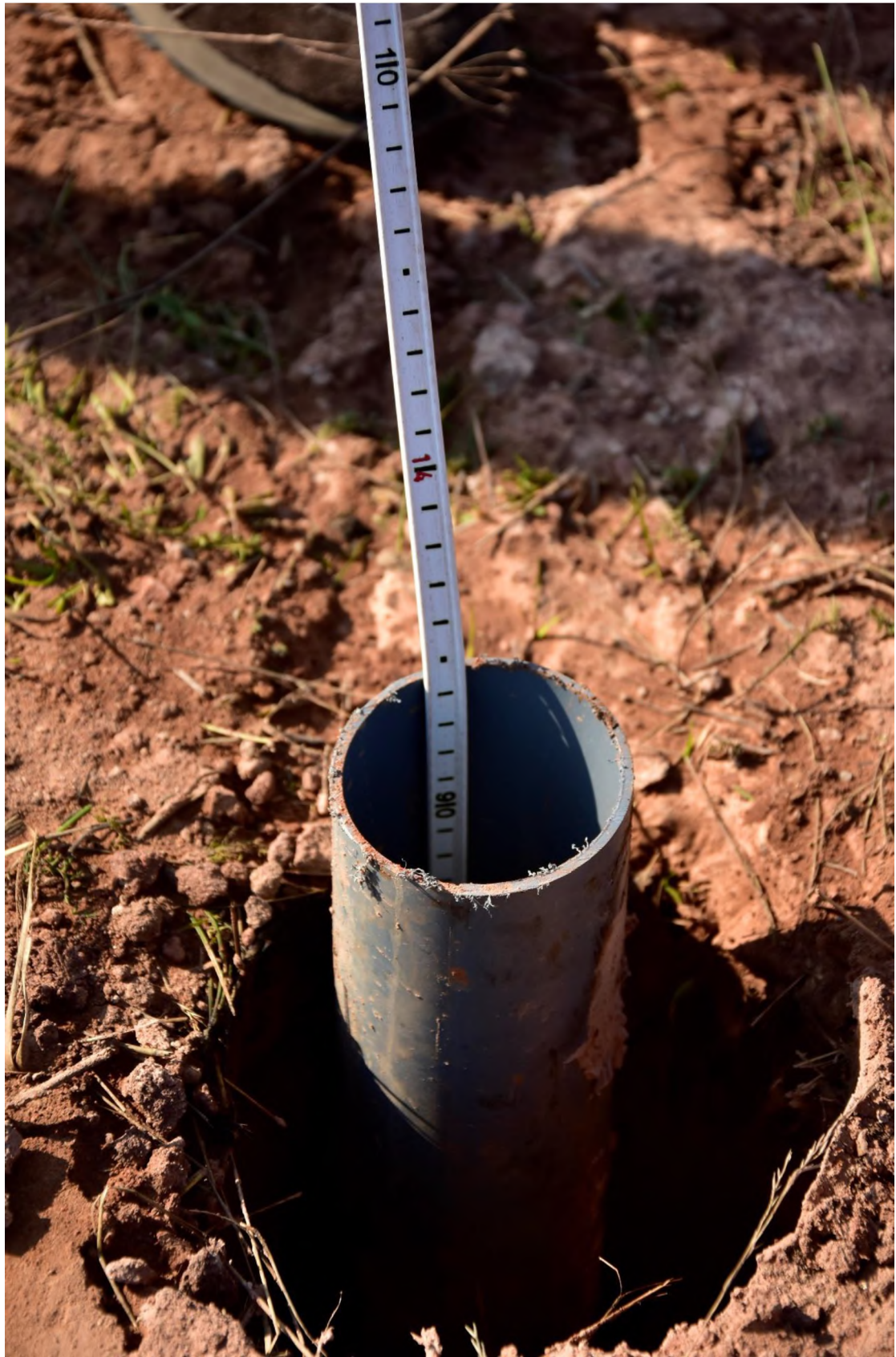
Obrázek 4 - Měření hladiny podzemní vody
