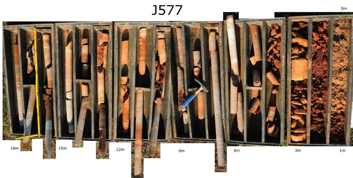
Obrázek 8 - Jednotlivá jádra rozdělená po metrových délkách, vrt J577
