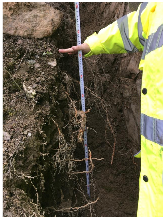
Obrázek 52. - Ručně kopaná sonda OPI
