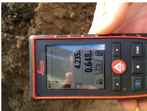
Obrázek 53. - Měření hloubky kopané sondy
