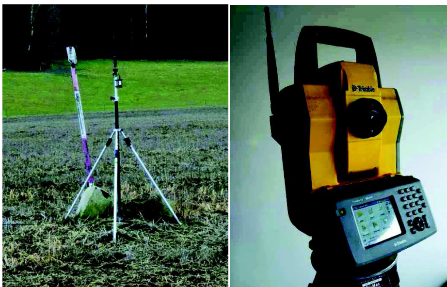
Obrázek 1: Výtyčka s aktivním odrazným hranolem (vlevo), Totální stanice Trimble 5603 DR200+ (vpravo) [vlastní zroj]
