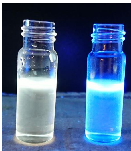
Obr. 8: Bílá fluorescence 5-fenyl-4-hydroxy-2-(4-methylfenyl)-1,3-oxazolu 4b v DMSO vlevo a modrá fluorescence téže látky v THF vpravo.
