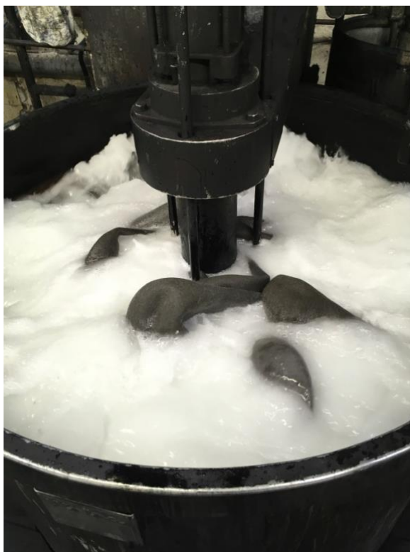
Obrázek 16: Otevřený barvicí aparát s polotovary před přidavkem barviva [13]
