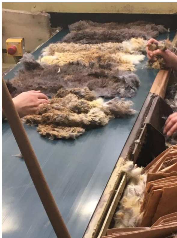
Obrázek 10: Vybírání kousků kůží a nečistot v nařezaných kožkách [13]
