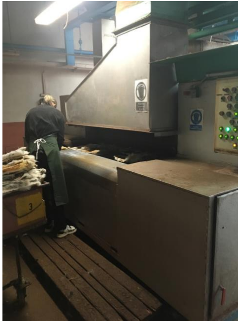
Obrázek 7: Vkládání namořených kožek do průběžné sušárny [13]
