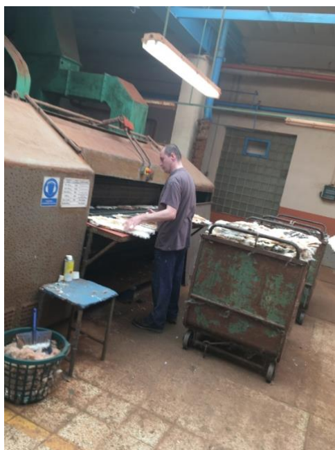
Obrázek 8: Odebírání kožek z průběžné sušárny a rovnání na vozík [13]
