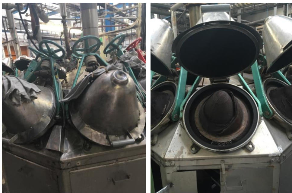
Obrázek 15: Uzavřený konusový barvicí aparát během barvení (vlevo) a otevřený konusový barvicí aparát s obarveným polotovarem (vpravo) [13]
