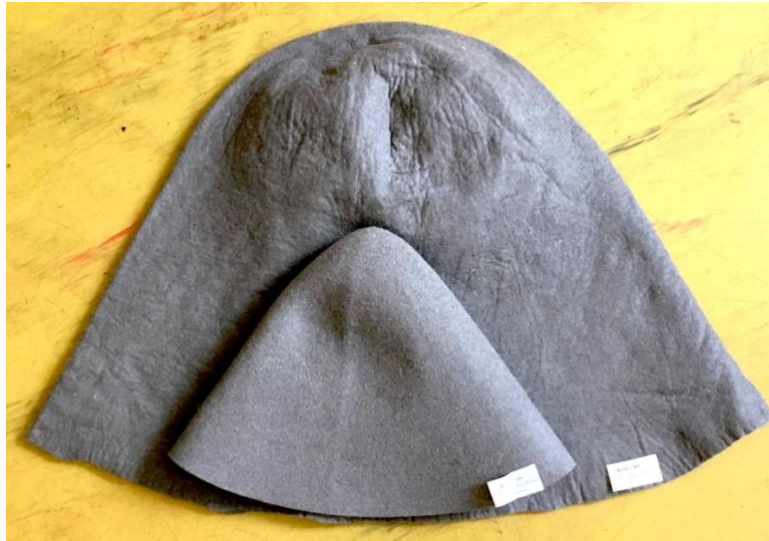
Obrázek 21: Porovnání velikosti materiálu po suchém plstění vůči surovému polotovaru [13]
