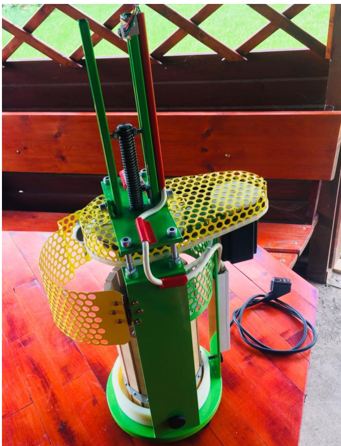
Obr. G. 2 – Pohled na vřetenový lis zleva
