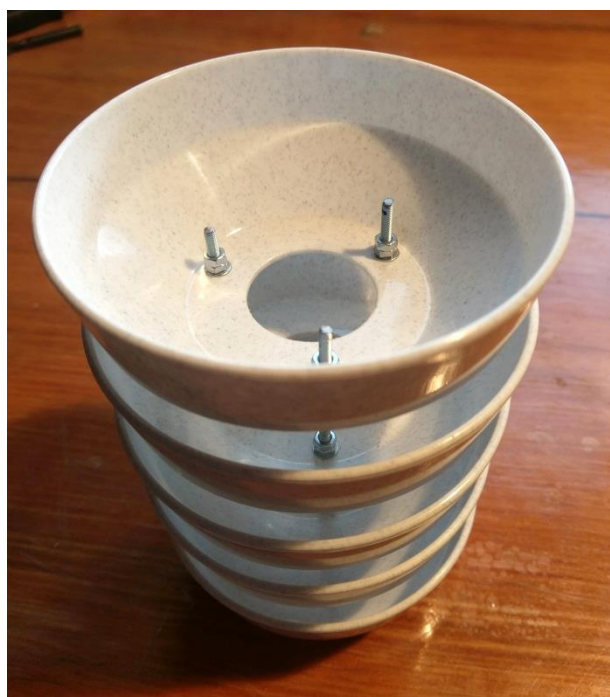
Obrázek 9 – Konstrukce radiačního štítu
