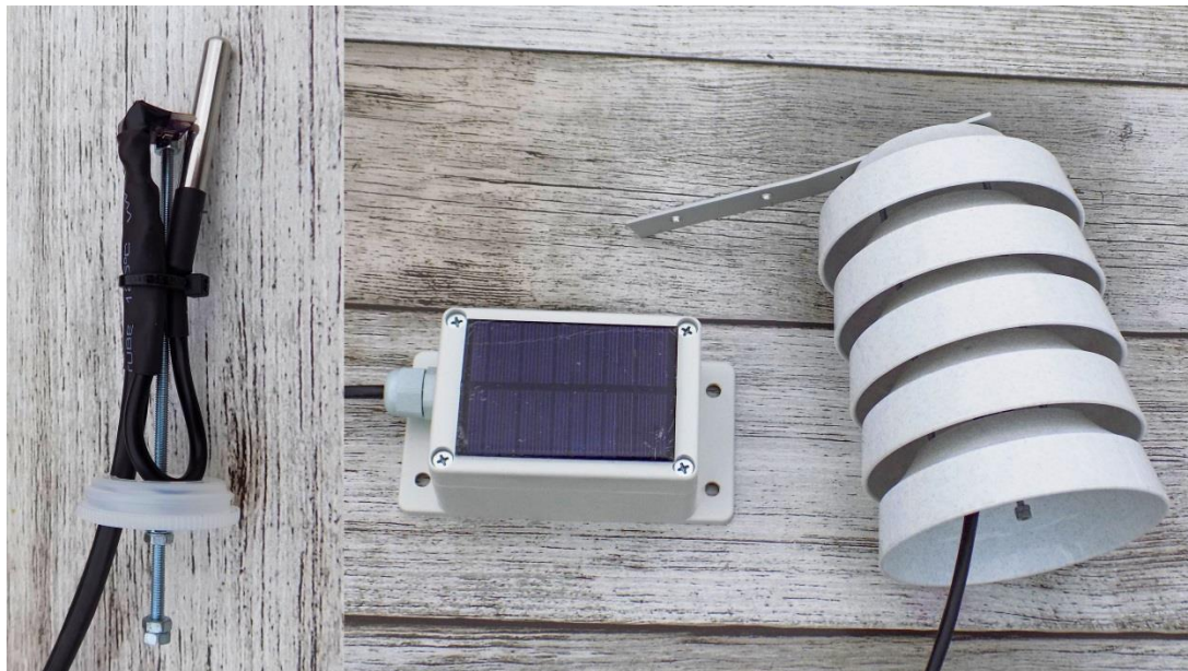
Obrázek 8 – Senzory, krabička s elektronikou a radiační štít
