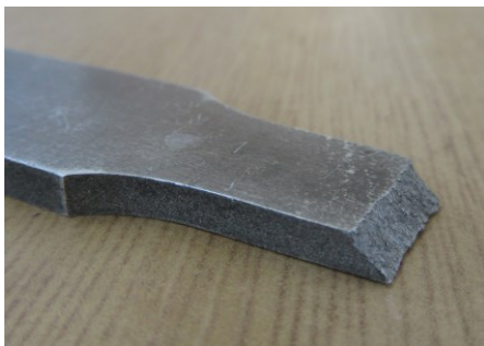
Obr. 9.3. Vzorek tahové zkoušky hliníkové slitiny. Šířka 11 mm, tloušťka 3 mm.
