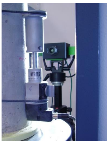
Obrázek 38 Uspořádání zkoušky: modul pružnosti, 2D DIC, Suchánek et al. (2017c)
