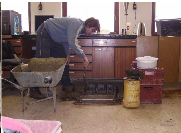
Obrázek 27 Zpracování čerstvého SCC betonu
