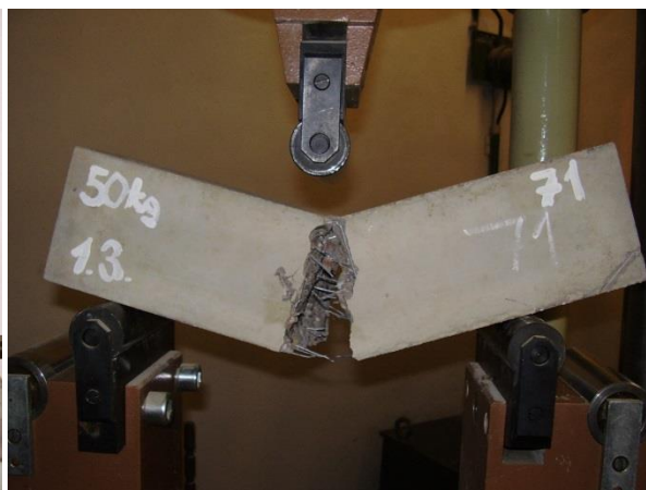
Obrázek A 12 Zkouška pevnosti v tahu ohybem (100 x 100 x 400 mm)
