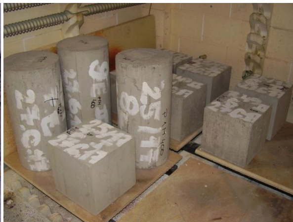
Obrázek A 28 Zkušební tělesa 25_2017žih po teplotním namáhání na 400 °C
