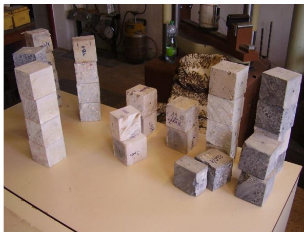
Obrázek 31 Krychle (upravené řezem) pro stanovení převodního součinitele
