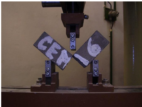
Obrázek 34 Stanovení pevnosti v tahu ohybem (cementová tělesa)
