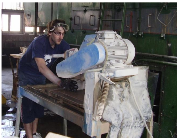
Obrázek 30 Úprava těles řezem na pile s diamantovým kotoučem, řezání pod vodou
