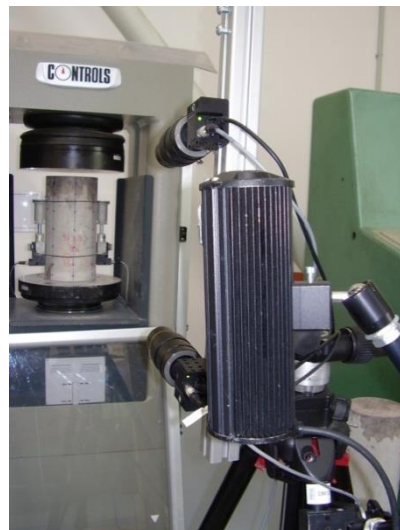
Obrázek A 14 Uspořádání zkoušky: modul pružnosti, 3D DIC, detail
