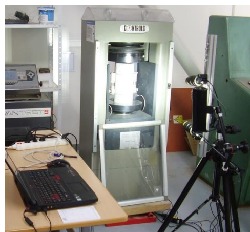
Obrázek 39 Uspořádání zkoušky: modul pružnosti, 3D DIC
