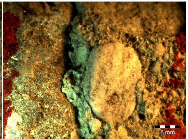
Obrázek F 22 Porušená tranzitní zóna C30/37žih na 1049 °C
