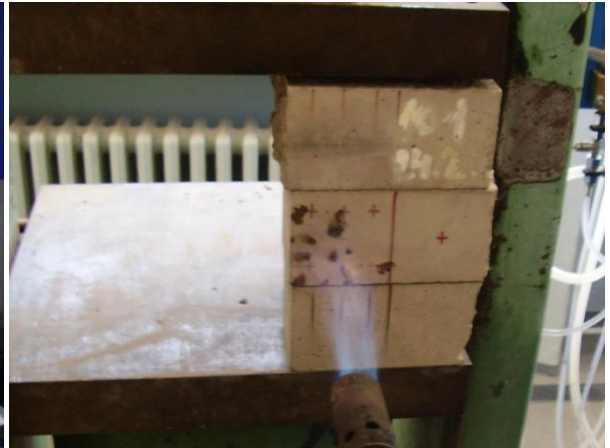
Obrázek A 20 Zatěžování lokálním požárem, detail difuze vodní páry, těleso Syn2_2013_žih
