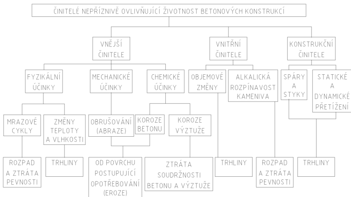
Obrázek 1 Schéma rozdělení činitelů ovlivňujících životnost betonových konstrukcí, upraveno z (Bilčík et al., 2003)
