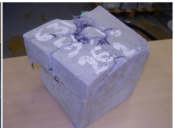
Obrázek A 24 Poškozené zkušební těleso – krychle (50_2013žih), zatíženo na 1049 °C
