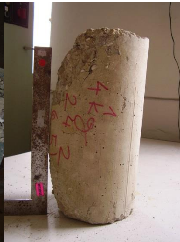
Obrázek A 22 Poškozené zkušební těleso – válec (4PP_2013žih), zatíženo na 1049 °C
