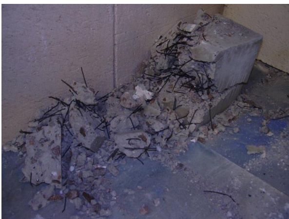
Obrázek A 23 Poškozené zkušební těleso – hranol (50_2013žih), zatíženo na 1049 °C
