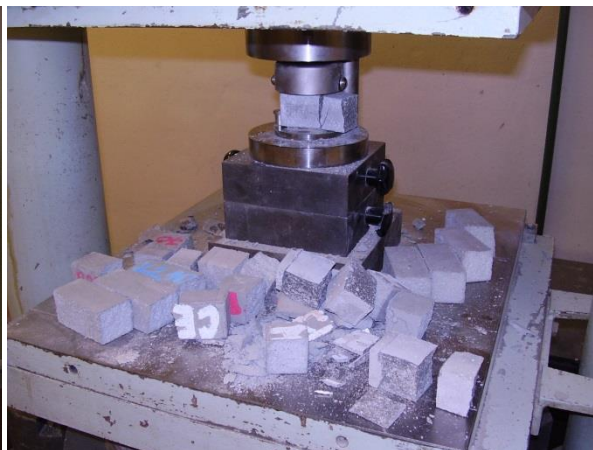
Obrázek 35 Stanovení pevnosti v tlaku (cementová tělesa)
