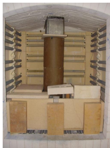
Obrázek A 16 Pohled do prostoru elektrické pece
