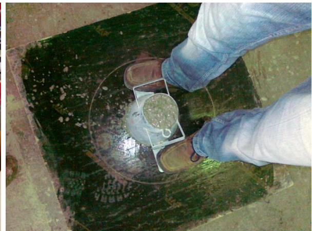
Obrázek A 4 Zkoušení čerstvého SCC: zkouška sednutí-rozlitím (LWSSC)
