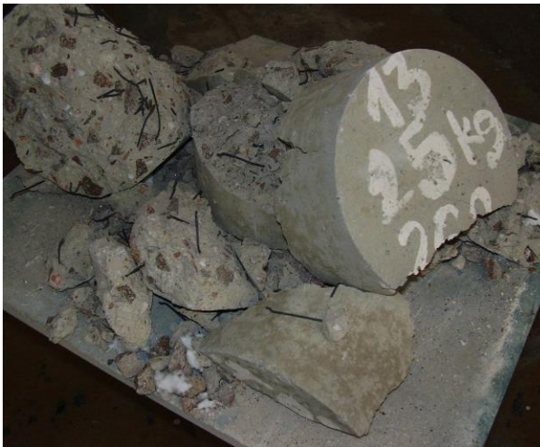
Obrázek A 21 Poškozené zkušební těleso – válec (25_2013žih), zatíženo na 1049 °C
