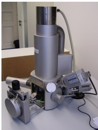
Obrázek F 1 Elektronový mikroskop (TESCAN VEGA 5130SB) s mikroanalyzátozem EDXA (Bruker Quantanox 200)
