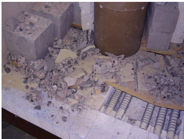
Obrázek A 27 Poškozené zkušební těleso – hranol (Syn2_2013žih), zatíženo na 750 °C
