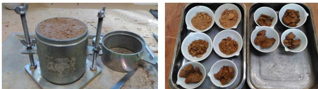
Obr. 27: Proctorova zkouška – seříznutý dílčí vzorek v moždíři, reprezentativní vzorky před vysušením (zleva).
