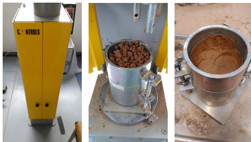
Obr. 26: Proctorova zkouška – hutnicí přístroj, dílčí vzorek v moždíři před a po zhutnění (zleva).
