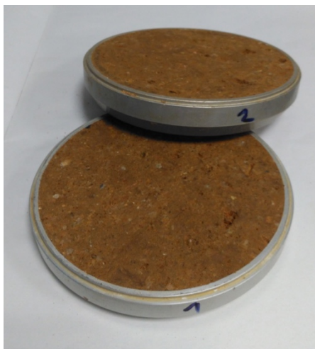
Obr. 30: Edometrické prstence se zhutněnou testovanou zeminou.
