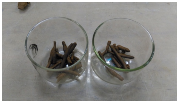
Obr. 25: Zkušební dílčí vzorky s vlhkostí na mezi plasticity.
