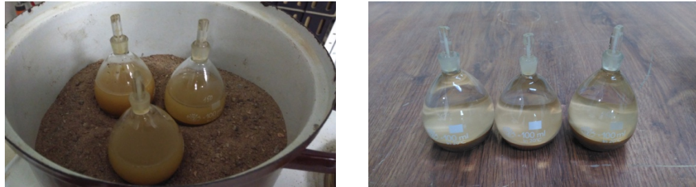
Obr. 19: Pyknometry v pískové lázni (vlevo) a pyknometry se vzorkem a vodou (vpravo).
