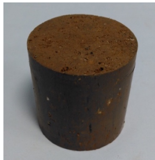
Obr. 37: Zkušební tělíčko před zahájením smršťovací zkoušky.
