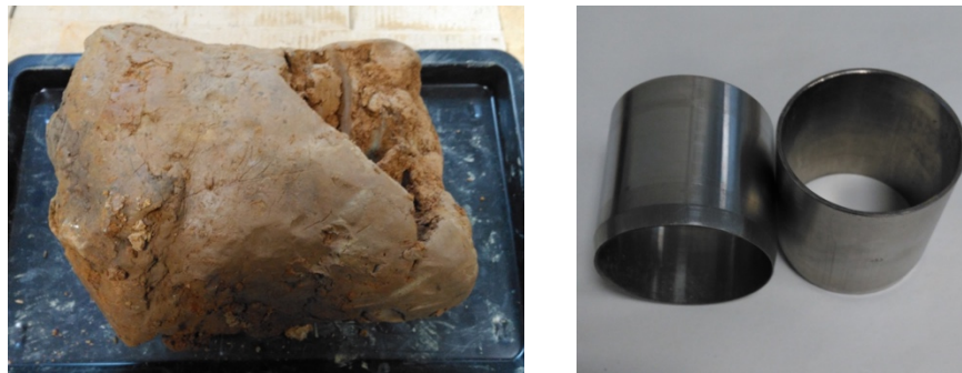
Obr. 18: Část vrtného jádra (vlevo), zkušební vyřezávací prstence (vpravo).
