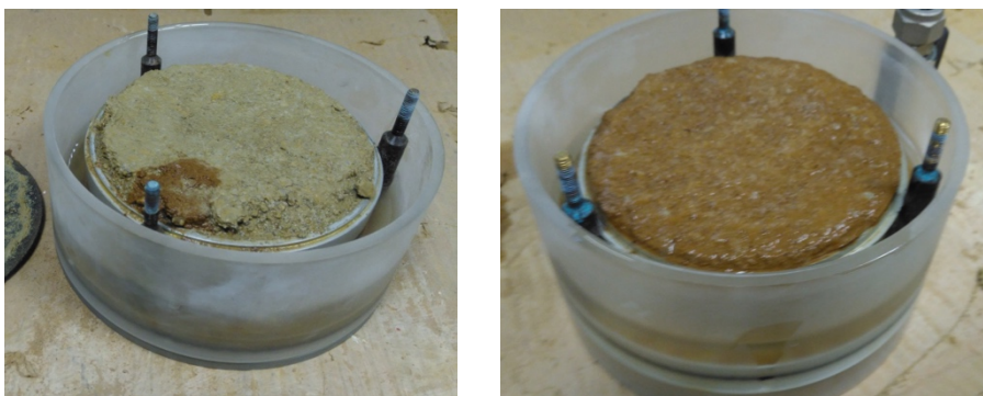
Obr. 32: Ukázka vzorků zemin po nabobtnání – Chvaletice vlevo, Jindice vpravo.
