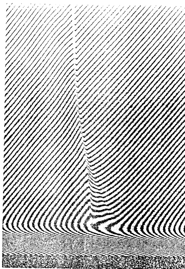
Obr. 3.7: Interferogram interakce rázové vlny s teplotní vrstvou /rázová vlna se pohybuje doprava/
