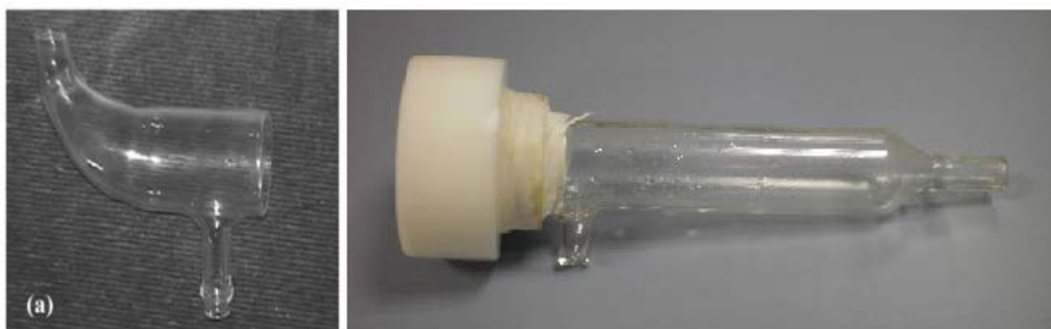
Obrázek 25.: Single-pass mlžná komora [153]
