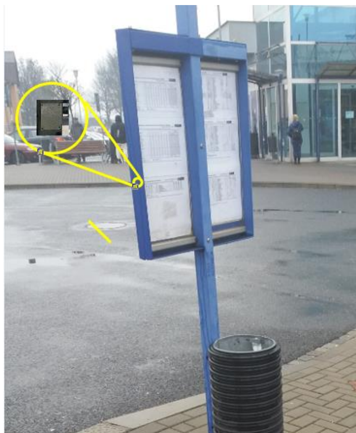
Obrázek 46 Návrh označnicku s Braillovým písmem
